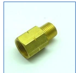
56-04 CONECTOR PARA REG. TMO- 540 DE 3/8 A 9/16-18 ACETILENO
